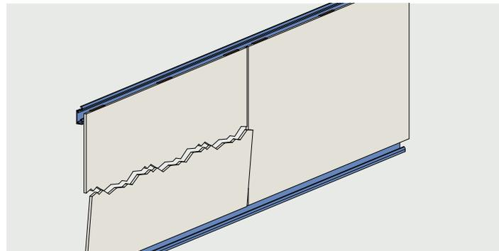
No requiere malla trasera; en caso de rotura no se desprende. Los ganchos superiores lo mantienen suspendido y los inferiores lo fijan, evitando su caída.
