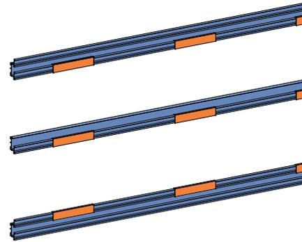
Os ganchos são colocados previamente na perfilaria, com um cordão de polímero MS aplicado in loco para a colocação do revestimento.
