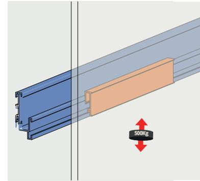
Gancho com adaptação precisa do revestimento ao perfil horizontal.
