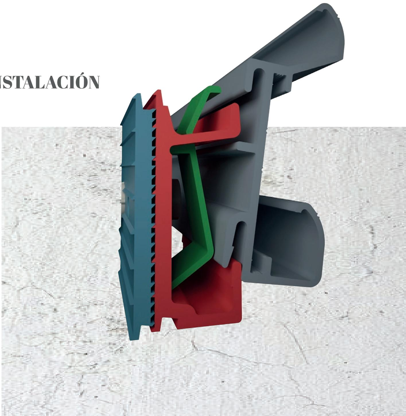
La unión del perfil horizontal con el soporte CLAW, por su peculiar diseño, permite los movimientos de dilatación, debido a que la fijación se realiza clipada y no con tornillos que bloquean el movimiento. Esta movilidad permite que el perfil se acomode a los cambios de temperatura y retracciones del edificio sin causar tensiones o daños estructurales.
