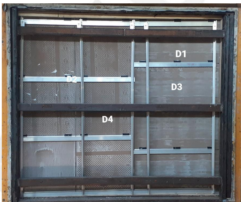
Foto nº 02 Comportamento sob cargas uniformemente distribuídas – posicionamento dos deflectômetros.
