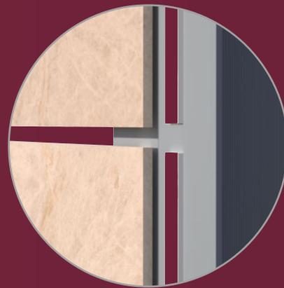
Este sistema básico consiste na utilização de perfis primários, nos quais o revestimento é fixado na superfície do perfil através de um polímero de alta tecnologia e fita dupla face. Durante a cura do polímero, o revestimento permanece apoiado e a fita dupla face garante a espessura constante de 3mm e atua como força de tração, impedindo que o polímero escorregue ou se desprenda da superfície.
