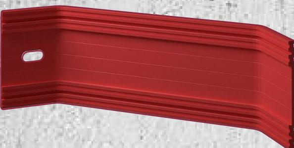
Haverá um espaçamento de 1 cm na junção vertical entre um perfil e outro. Os perfis serão fixados na parte superior em um ponto fixo da ménsula de sustentação e na parte intermediária e inferior através de um furo alongado na ménsula. Essa abordagem é crucial para acomodar as dilatações dos perfis.
