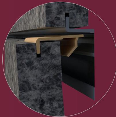
Sistema para revestimentos com ranhuras nas extremidades, altamente versátil e dinâmico. Permite que os revestimentos sejam instalados de forma livre, possibilitando a movimentação e a remoção. Este sistema é adequado para oferecer uma solução prática e flexível, sem a necessidade de aplicação de cola ou outros adesivos.
